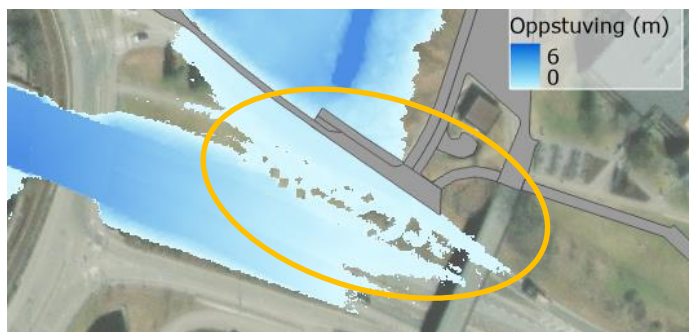
Figur 15 viser et utsnitt av adkomstveien ved simulert PMF. Atkomstveien, som ved avkjørselen ligger på kote 105,5, vil ligge under vann.
