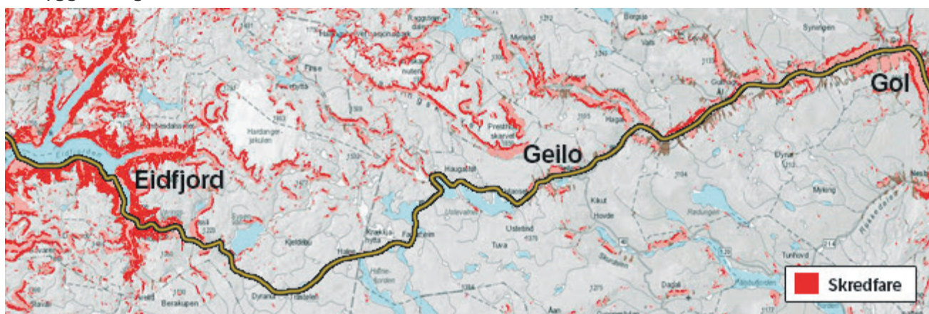
Figur 2: Skred- og rasfare langs prosjekstrekningen Bu – Gol.
