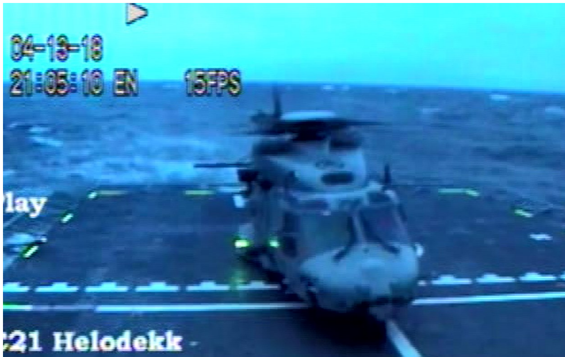
Figur 1. Helikopteret umiddelbart etter at høyre understell kollapset. Utklipp fra Sjøforsvarets video fra 13.4.18 (tidsstempelet på bildet er ikke korrekt)
