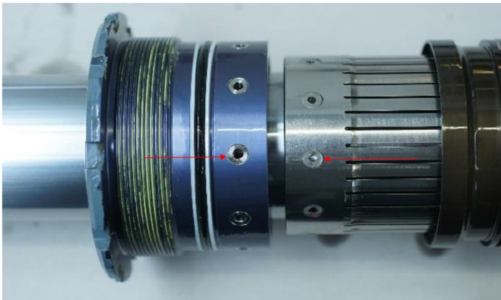
Figur 4. De røde pilene peker på en av de avbrutte bryteboltene. Foto: Fokker LG
