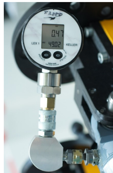
Figur 7. Instrumentet Fokker LG benyttet under undersøkelsen av MLG SP6010.
