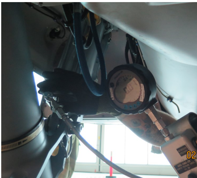
Figur 6. Trykkmåling foretatt med slangetilkobling til instrument 2. mai 18.
