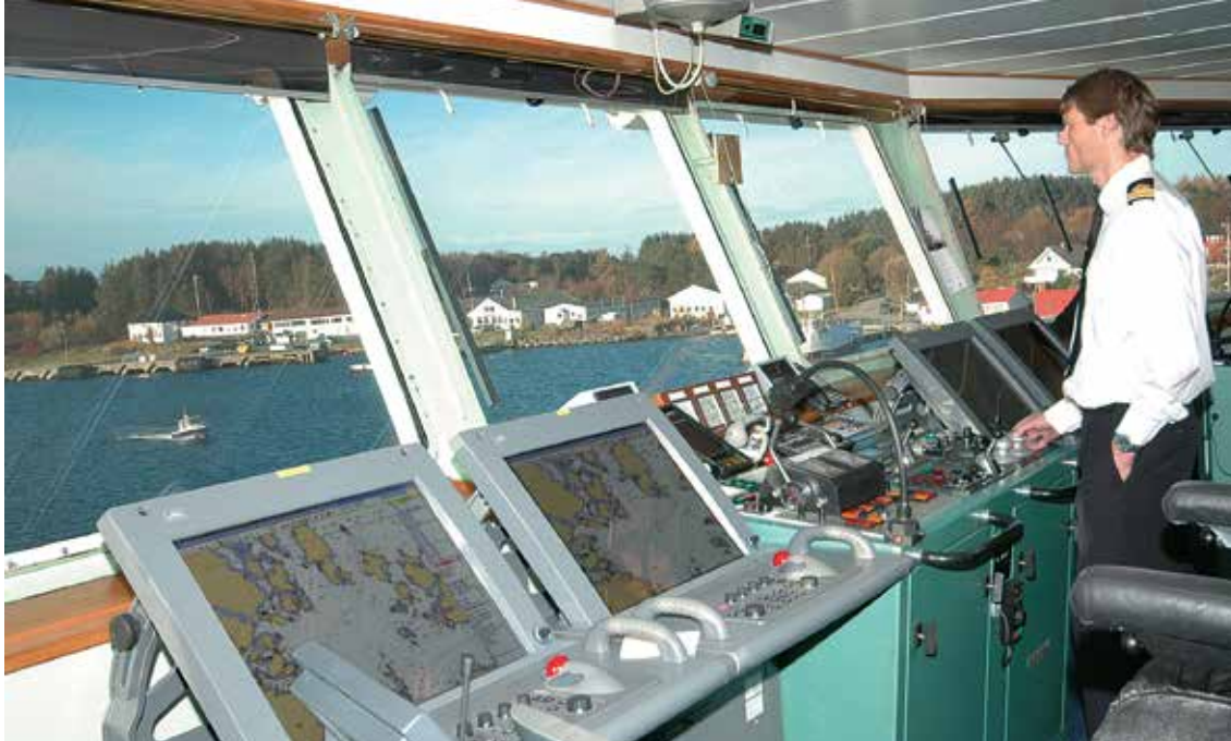
Skipsbro med elektronisk sjøkart om bord i skoleskipet Gann. Foto: Kartverket.
