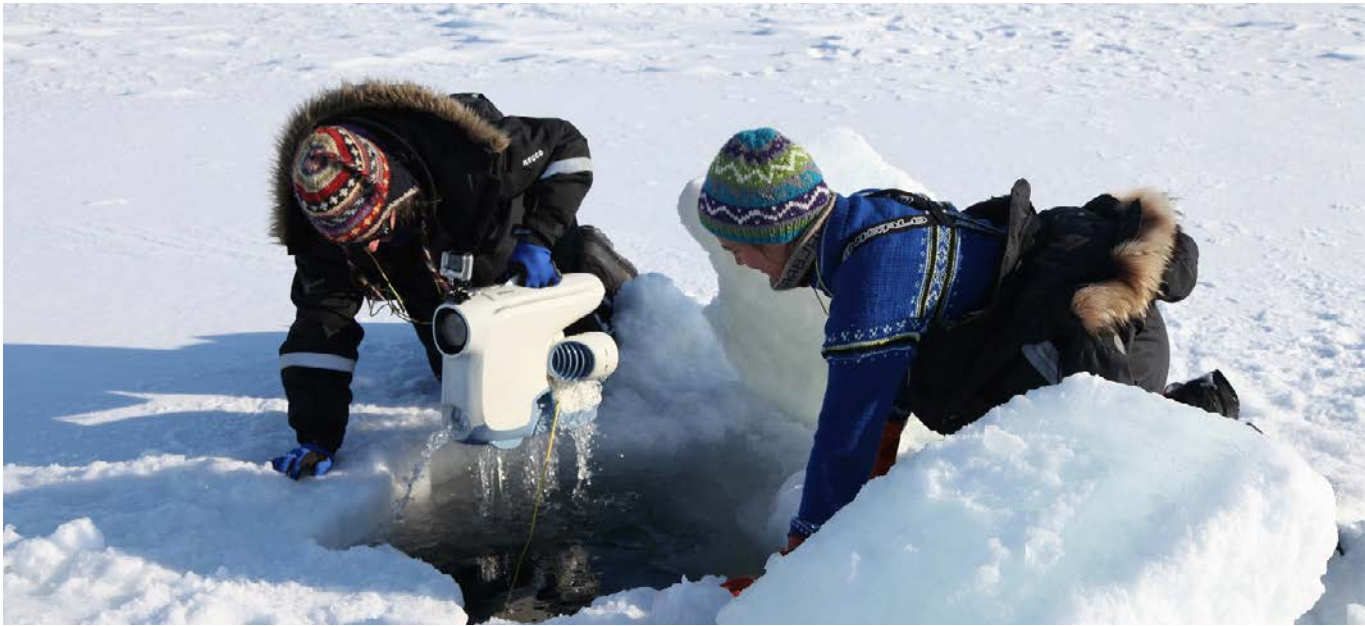
Undervannsdronen BluEye, utviklet av NTNU, testes av UNIS studenter i Van Mijenfjorden. Foto: Martin Ludvigsen / NTNU og UNIS.
