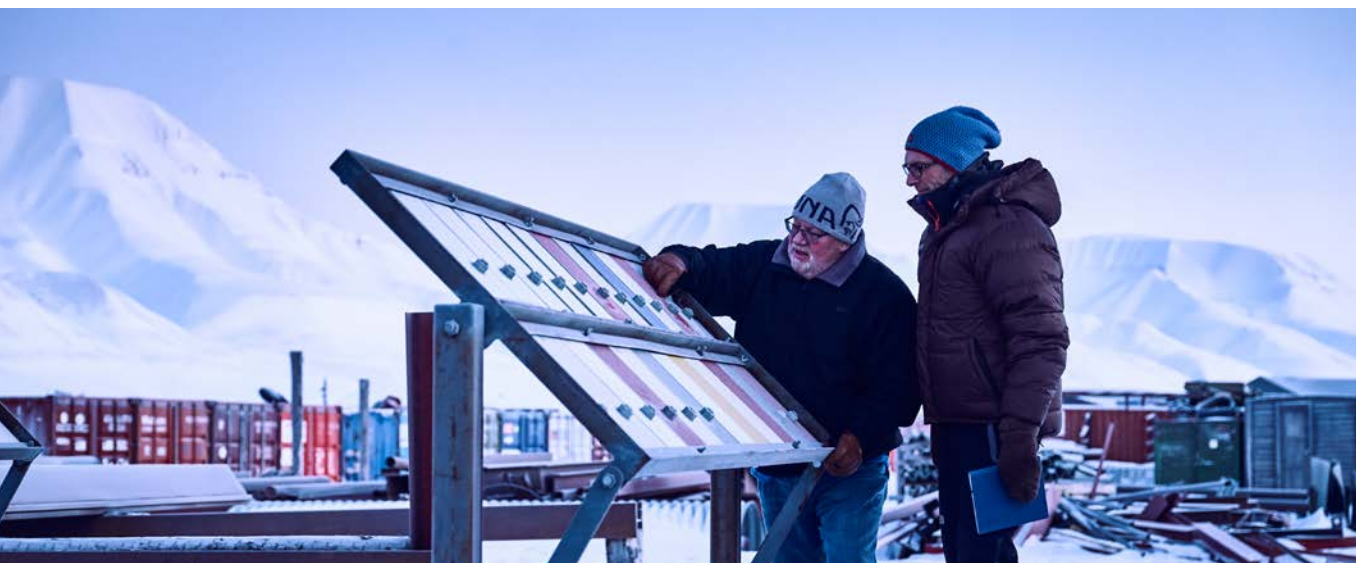
Svein Erik Andresen og Anders Skilbred i Jotun studerer malingprøver som testes i arktisk klima ved Jotuns teststasjon i Longyearbyen. Foto: Morten Rakke / Jotun
