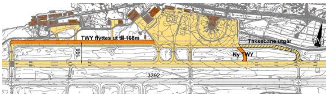
Figur 23 - Flytting av taksebane W
