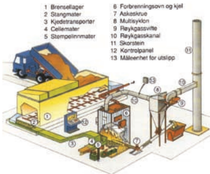
Hovedkomponentene i et biobrenselanlegg (Ferrolli/Energigården)
