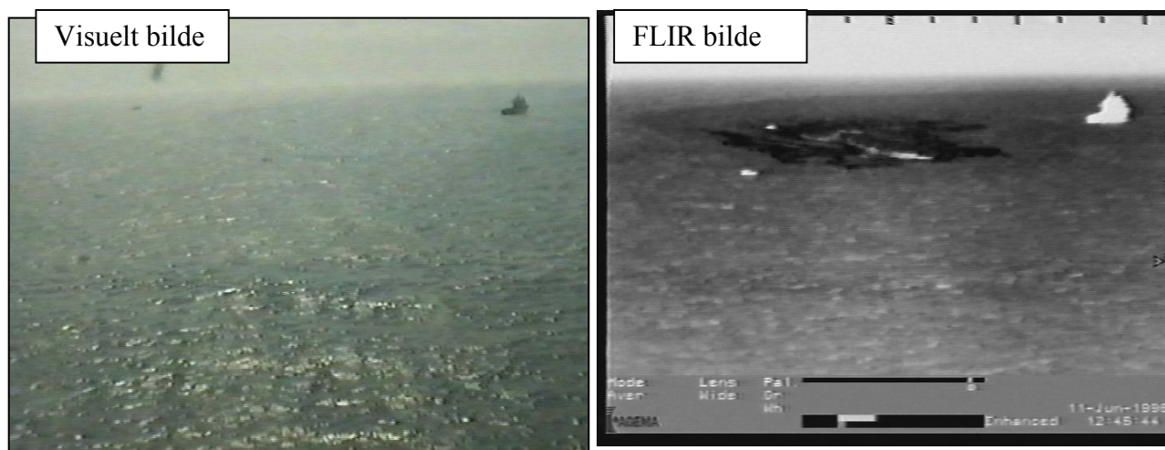
Figur 3.5 Eksempel på bilde tatt med FLIR kamera sammenlignet med visuelt video bilde. IR-hvitt: tykk olje/emulsjon ( < 200 \mu\text{m} ); IR-svart: tynn olje ( 5-200\mu\text{m} ).
