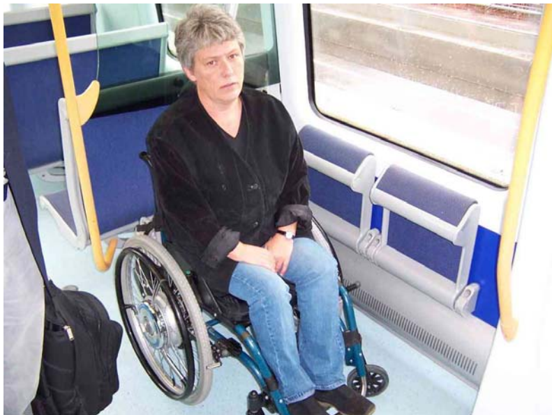
Rullestolplassen er bakovervendt og utstyrt med 2 klappseter Foto: Ole Øystein Bakke
