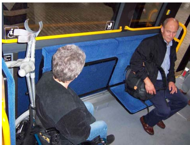
Rullestolplassen var bakovervendt, og det var montert to klappseter som kan benyttes når rullestolplassen ikke benyttes.
