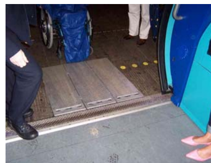
På S-toget var det sammenleggbar rampe som var hensiktsmessig oppbevart i et eget skap ved siden av døren når den ikke var i bruk. Foto: Ole Øystein Bakke
