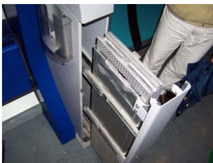
På S-toget var det sammenleggbar rampe som var hensiktsmessig oppbevart i et eget skap ved siden av døren når den ikke var i bruk. Foto: Ole Øystein Bakke
