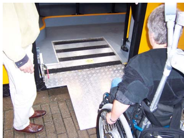
Manuell fastmontert rampe Foto: Ole Øystein Bakke
