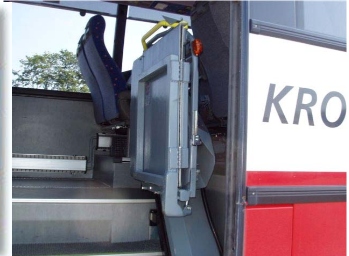
Elektrisk heis montert henholdsvis innfelt i trapp (til venstre) og sidemontert (til høyre)
