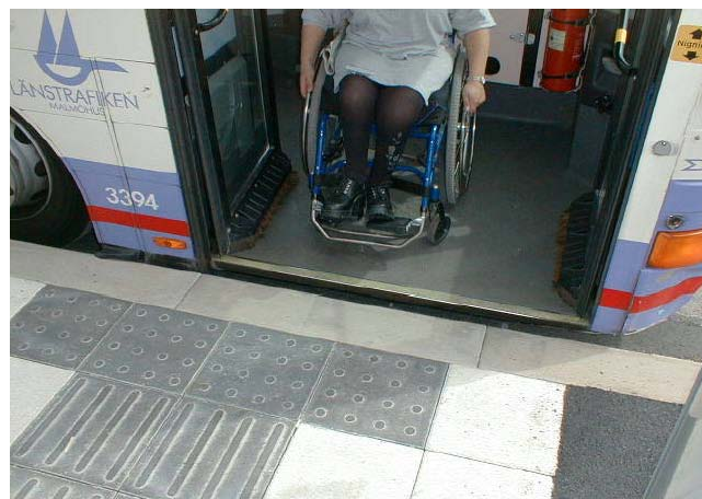
Med kneling og lavgulv kan man nesten klare seg uten rampe. (Merk for øvrig ledelinje som fører frem til fordør) Foto: Skånetrafiken
