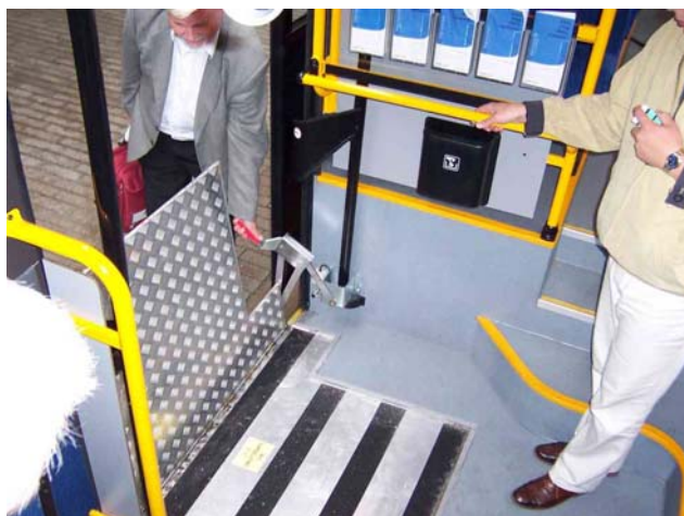
En enkel hendel gjør det enklere og mer "renslig" å vippe rampen ut og tilbake. Løsning på bussene i København. Foto: Ole Øystein Bakke
