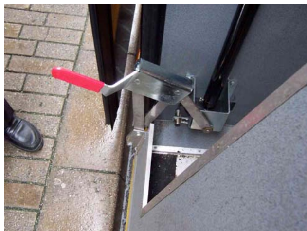
En enkel hendel gjør det enklere og mer "renslig" å vippe rampen ut og tilbake. Løsning på bussene i København. Foto: Ole Øystein Bakke
