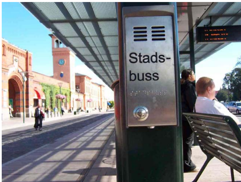
Ved å bruke denne trykknappen fås informasjon i tale om hvilke busser som kommer, med rutenummer og klokkeslett. Her fra holdeplass ved sentralstasjonen. Foto: Ole Øystein Bakke
