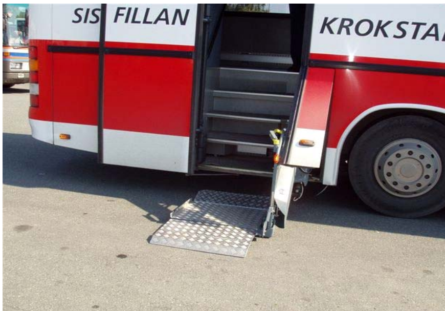
"Helseekspressen" er utstyrt med sidemontert elektrisk rullestolheis. Løsningen virker relativt improvisert, og heisen holder ikke bussdirektivets krav til minimum bredde som skal være 80 cm (heisen er av type Ulift TRP 300).
