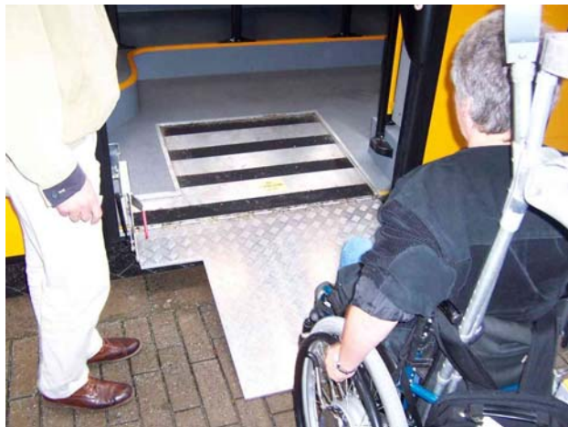
Rampen har ikke antisklibelegg, den er relativt smal, uten kantsikring og kantmarkering
