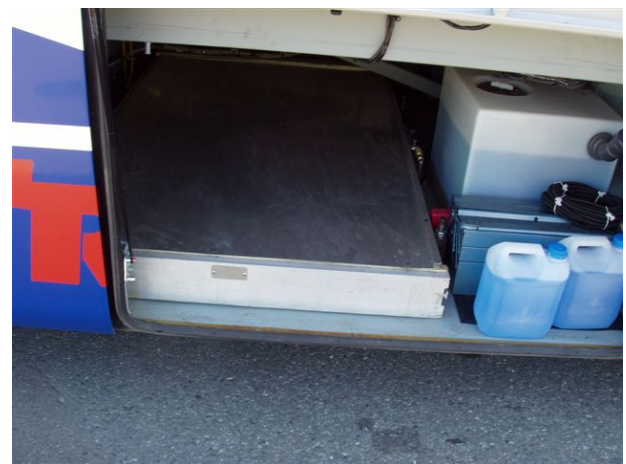
Innebygd kassettheis i trappen ved bakdør. Når heisen ikke er i drift ligger den helt innelukket i en kassett på tvers av bussen, skjermet for skitt, støv, snø og is. Foto: Asbjørn Hagerupsen
