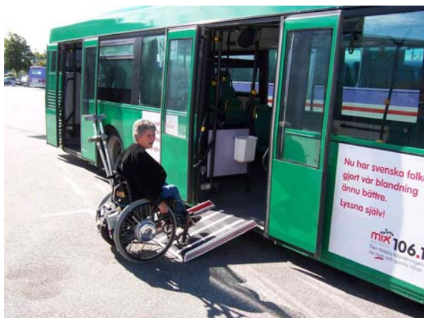
Når bussen kneler er det ikke mulig å klare seg selv uten plattform eller fortau, men med hjelp er det likevel mulig selv om bussen kun har en kort rampe. Foto: Ole Øystein Bakke
