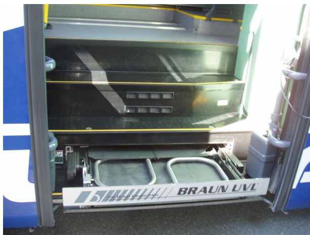
Innebygd kassettheis i trappen ved bakdør. Når heisen ikke er i drift ligger den helt innelukket i en kassett på tvers av bussen, skjermet for skitt, støv, snø og is. Foto: Asbjørn Hagerupsen
