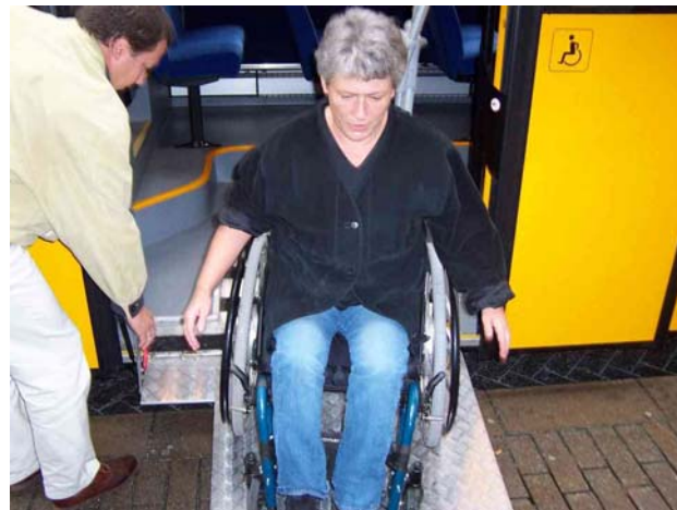
Her skal det ikke mye til før stolen kjører av rampen Foto: Ole Øystein Bakke
