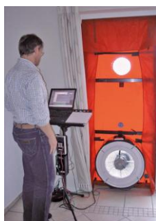
Figur 10 Tetthetsmåling i bygg med "Blower door" utstyr.
