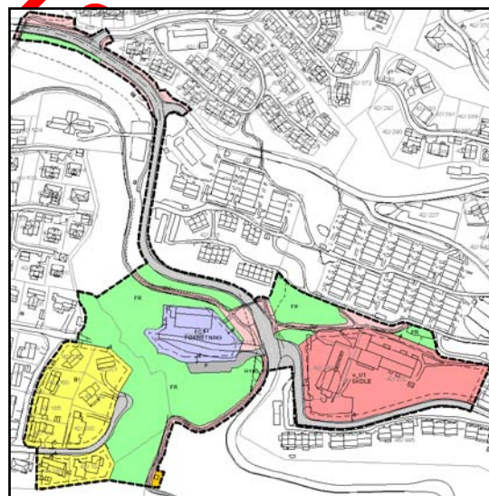
Figur 1-31: Grunnkartelementer som i eksempelet til høyre er tegnet ut sammen med reguleringsplanen er høydekurver, bygningsdata, veger og matrikkelgrenser. Grunnkartelementene tegnes ut med basiskart i gråtoner, uten fylte flater. Grunnkartet tegnes sammen med plankartet for å gjøre det lettere å kjenne seg igjen i kartet.
