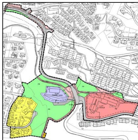
Figur 1-38: Grunnkartelementer som i eksempelet til høyre er tegnet ut sammen med reguleringsplanen er høydekurver, bygningsdata, veger og matrikkelgrenser. Grunnkartelementene tegnes ut med basiskart i gråtoner, uten fylte flater. Grunnkartet tegnes sammen med plankartet for å gjøre det lettere å kjenne seg igjen i kartet.
