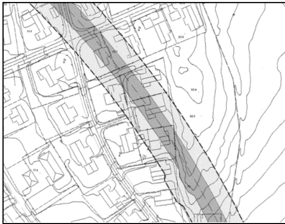
Reguleringsplan veg i tunnel (vertikalnivå 1 under bakkenivå) der arealbruk på bakken opprettholdes.
