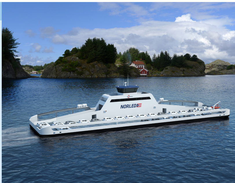
Miljøfergen ZeroCat™ blir Norges første batteridrevne ferje.
