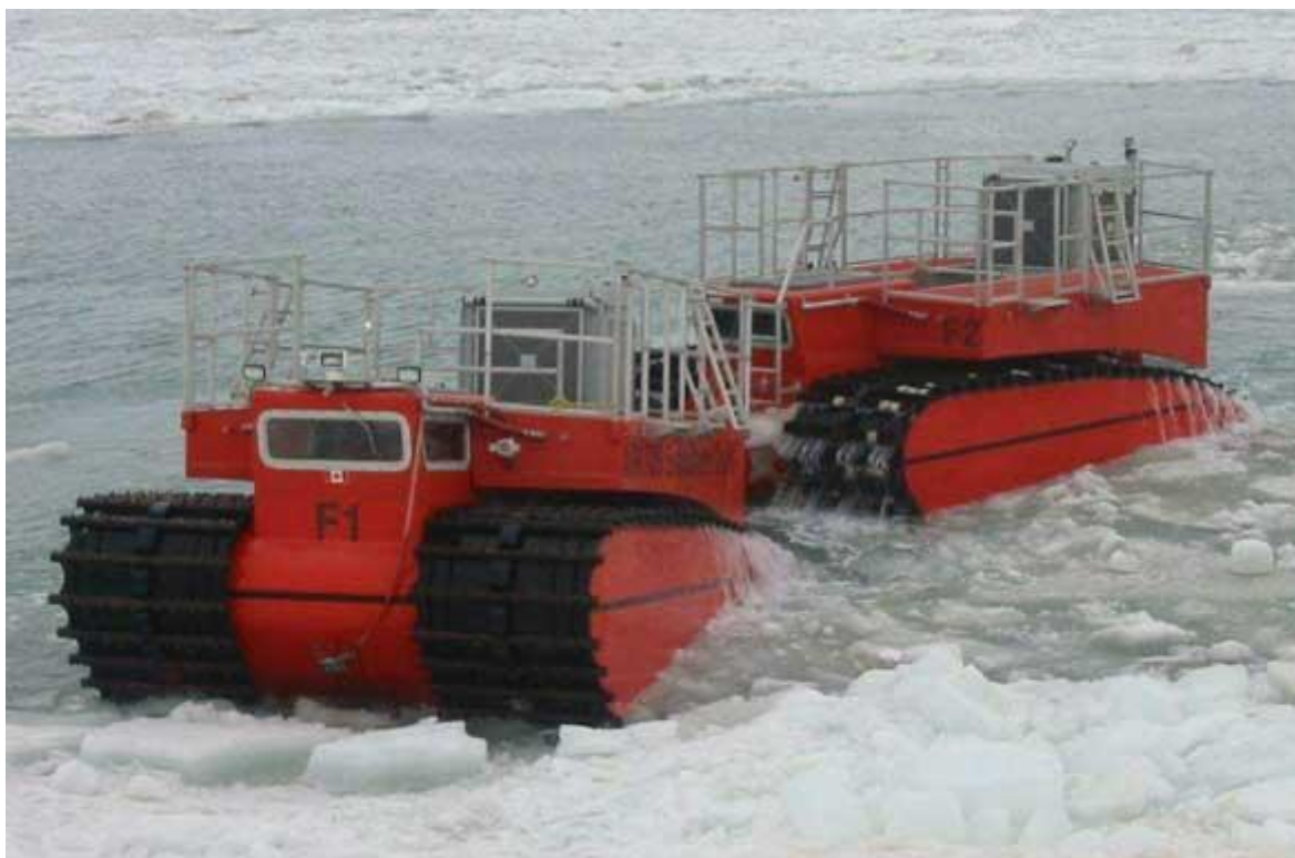
Bilde 5 Beltegående spesialfarkost for bruk som evakueringsmiddel offshore. Foto: Arktos Developments Ltd.
