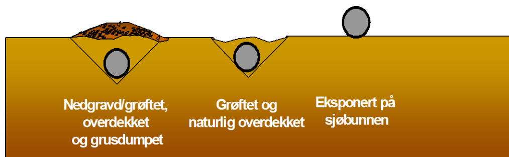
Figur 2.1 Plassering av rørledninger i forhold til havbunnen (Kilde: Nøland et al. 1999).
