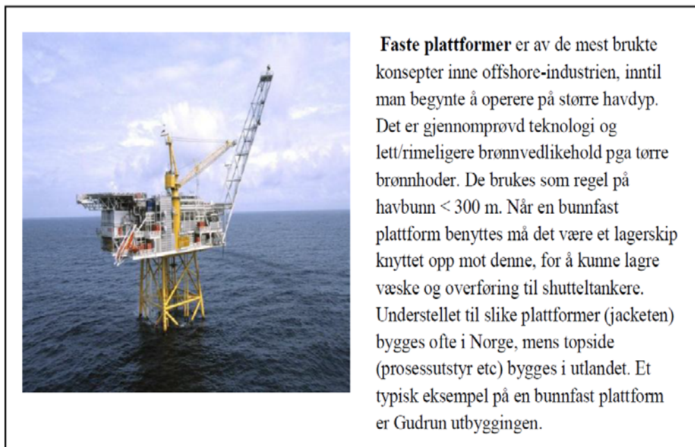
Figur 15 Nærmere om utbygging med fast plattform (OD 2012)
