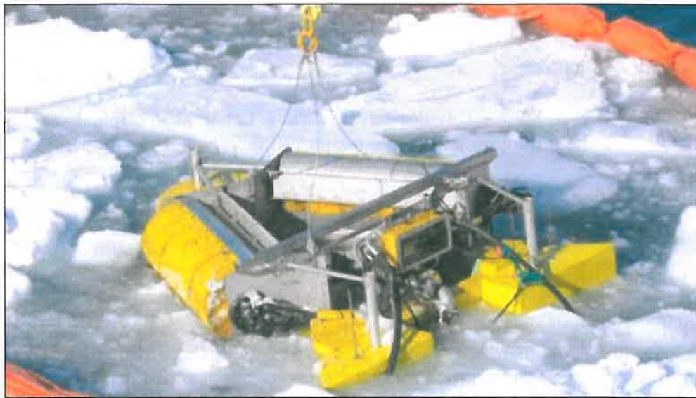
Figur 4-1 Testing av Framo "Ice skimmer" under feltforsøk i 2009.
