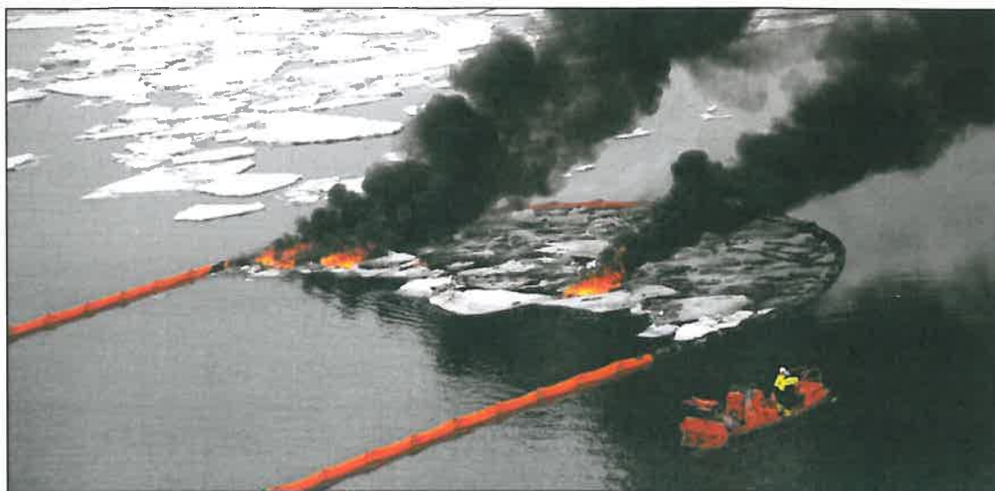
Figur 4-3 Brenning av olje samlet i brannsikker lense under feltforsøk i 2009.
