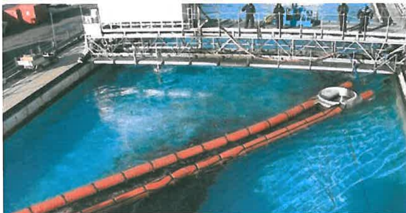
Figur 8-1 Testing av OilShaver ved Ohmsetts testfasiliteter (kilde: www.oilshaver.no )
