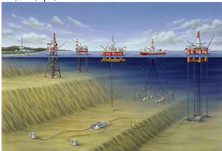
Fig 2 Ulike konsepter med økende havdyp. Fra venstre jacket, jack-up, Semi, FPSO-skip, TLP
