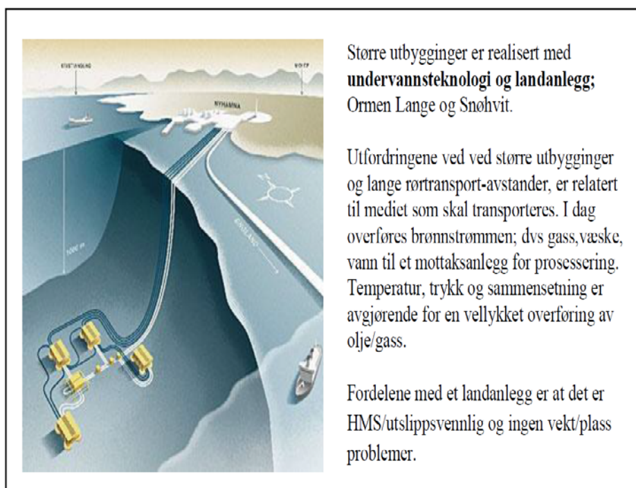
Figur 18 Nærmere om undervannsutbygging og landanlegg (OD 2012)
