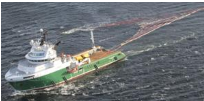
Figur 8-2 Testing av MOS Sweeper 50 Offshore, (kilde: MD Group)
