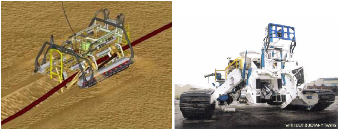
Figur 5-2. Illustrasjon av nedgrøfting ved vannspyling, venstre (Kilde: Gassco) og utstyr for nedgraving i hard havbunn (høyre).
