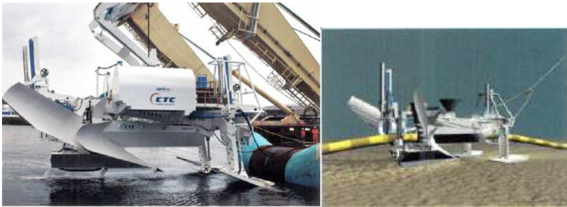
Figur 5-1. Eksempler på plog og plogeoperasjonen under rør.
