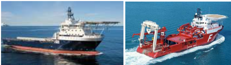
Figur 5-3. Offshore fartøy for bruk av vannspyliegrøfting (Island Pioneer) og plogging (Far Sovereign)
