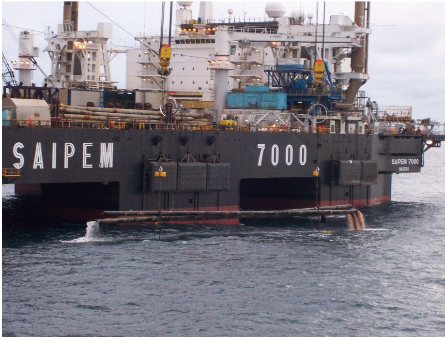
Figur 7-4. Løfting av rør fra havbunnen på Frigg-feltet.
