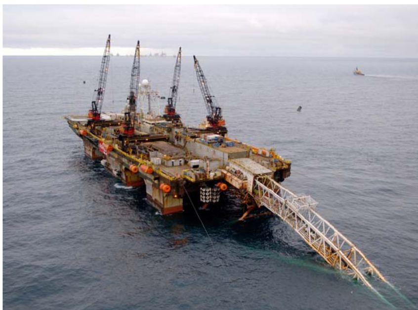
Figur 4-3 Exempel på ankarbaserat lägningsfartyg.
