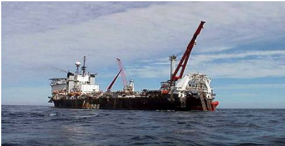
Figur 4-2 Exempel på offshore-lägningsfartyg med dynamisk positionering, DP.
