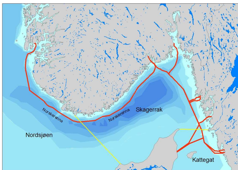
Figur 5-1. Havområder som vil bli berørt av legging og drift av Skanled rørledningen. Gule linjer antyder avgrensingen av de enkelte havområdene. Rød linje indikerer alternative traséer.
