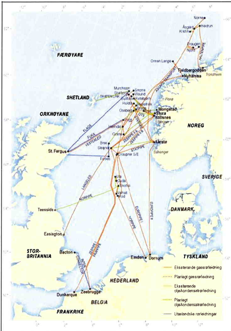
Figur 6-1 Eksisterende og planlagte gassrørledninger i Norskehavet nord for 62° (og Nordsjøen) fra OD (OD 2007). Kartet er ikke helt oppdatert, blant annet er nå rørledningene fra Ormen Lange og Langeled ferdig installert. Det dekker ikke nordområdene hvor det er etablert rørforbindelse fra Snøhvitfeltet til Melkøya.
