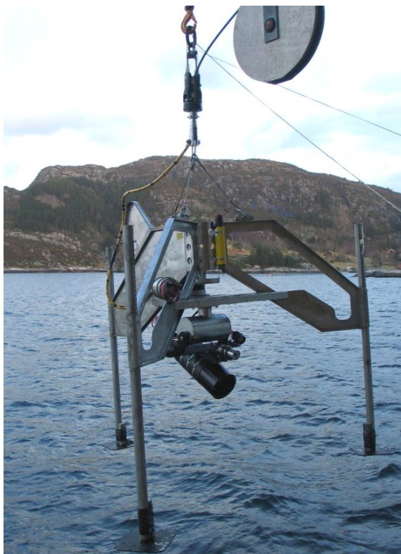
Figur 11: CANPOD – mobilt undervannskamera for fotografering av sjøbunnen
