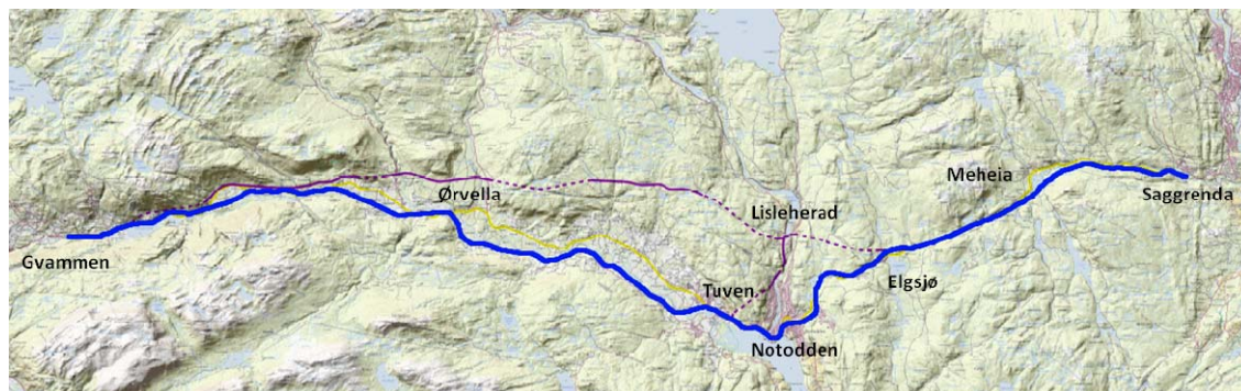
Figur 5-2: Konsept 3 er tegnet med blå strek og går igjennom Notodden sentrum og kan medføre en byggeteknisk relativt komplisert kulvert under Tinnelva.
