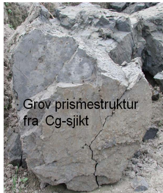
Figur 13. Smuldrende blokkstruktur fra B-sjikt til venstre og grov prismestruktur fra C-sjikt til høyre
