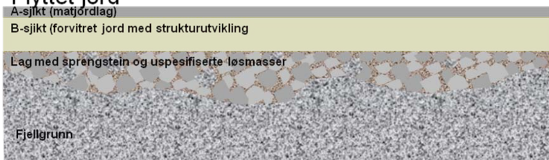
Figur 7. Principsskisse for flytting av jord med gjenoppbygging av opprinnelig lagrekkefølge.
