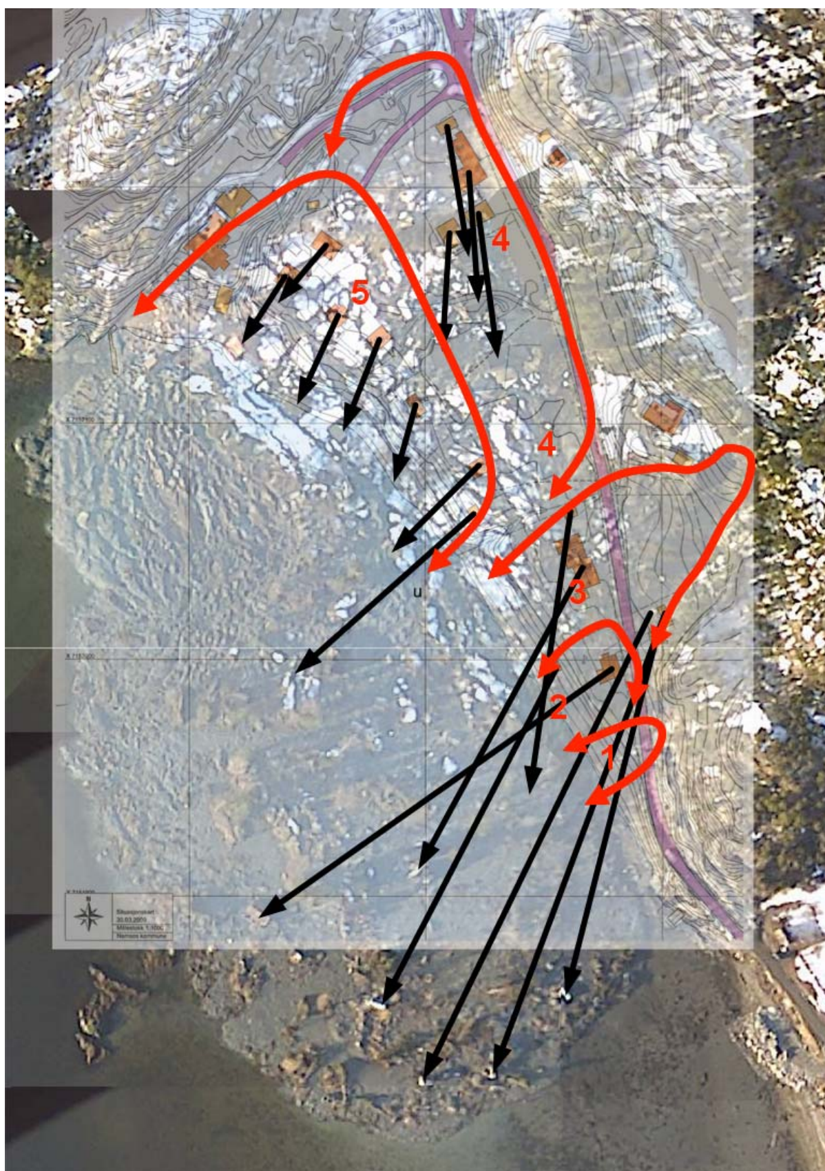
Figur 9 Kattmarka - skredets forflytninger av bygninger
