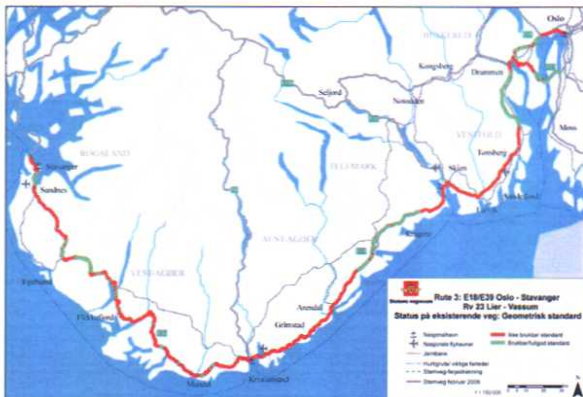
Figur 43 Geometrisk standard på eksisterende E18 og Rv39 (Stamveggrute 3). Mellom Grimstad og Kristiansand er veien i ferd med å bli bygget ut til fullgod standard. Det samme er tilfelle gjennom Vestfold frem til Langangen. Strekingen gjennom Porsgrunn kommune har for dårlig standard i forhold til trafikkbelastningen. Gjennom kommunene Bamble, Tvedestrand, Arendal og Grimstad er det trafiksikkerheten som er hovedutfordringen i forhold til standarden på veien.
