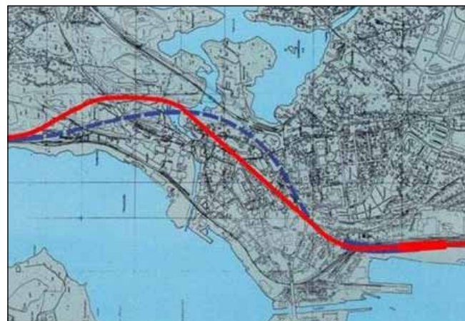
Figur 26: Hovedplan Nytt dobbeltspor Sandbukta – Moss – Kleberget. (Foreslått alternativ 2C er vist med rødt, og opprinnelig alternativ 2B vist med blått).
