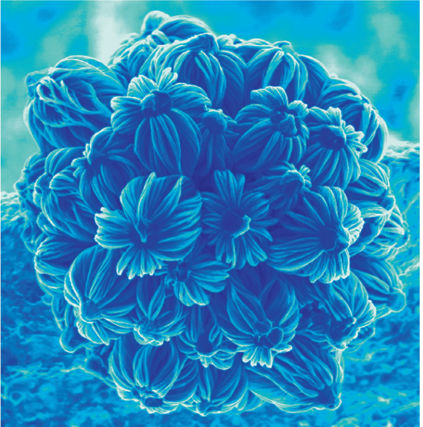
Nanobukett. Dette er et bilde av en 3-D nanostruktur som er bygget opp av tråder av silikonkarbid. Forskere undersøker mulige anvendelser for disse strukturene, herunder vannavstøtende belegg og som basis for en ny type solceller. Foto: Dr. Ghim Wei Ho og Prof. Sir Mark E. Welland, Nanoscience Centre, University of Cambridge, England.
